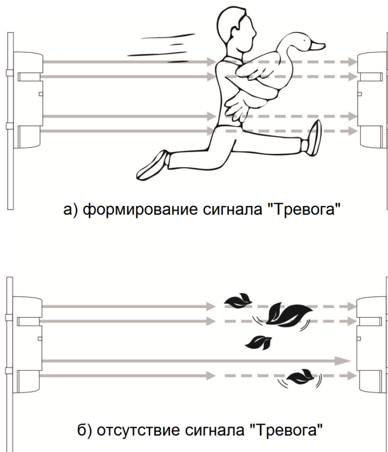
Рисунок 1.3 - Принцип действия извещателя
